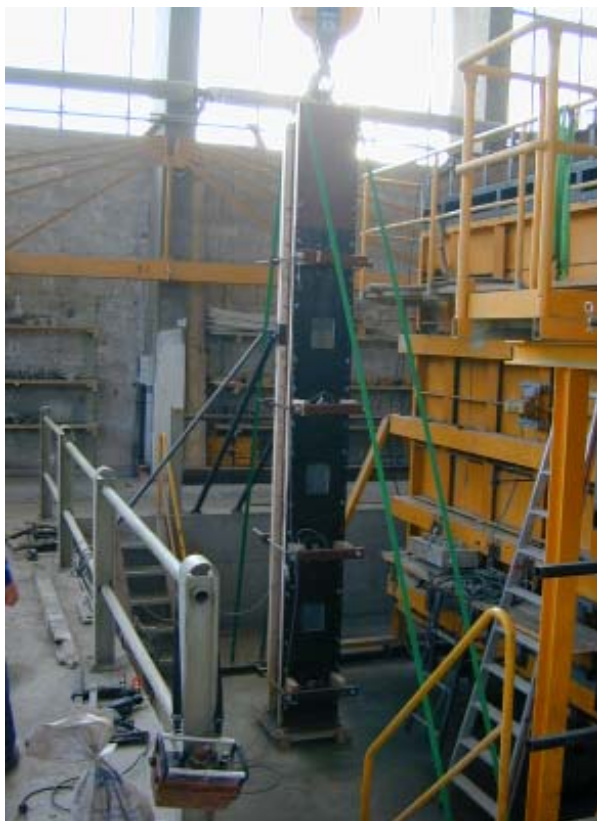
Bild 3.5 (links): Stützenschalung in Betoniergrube
